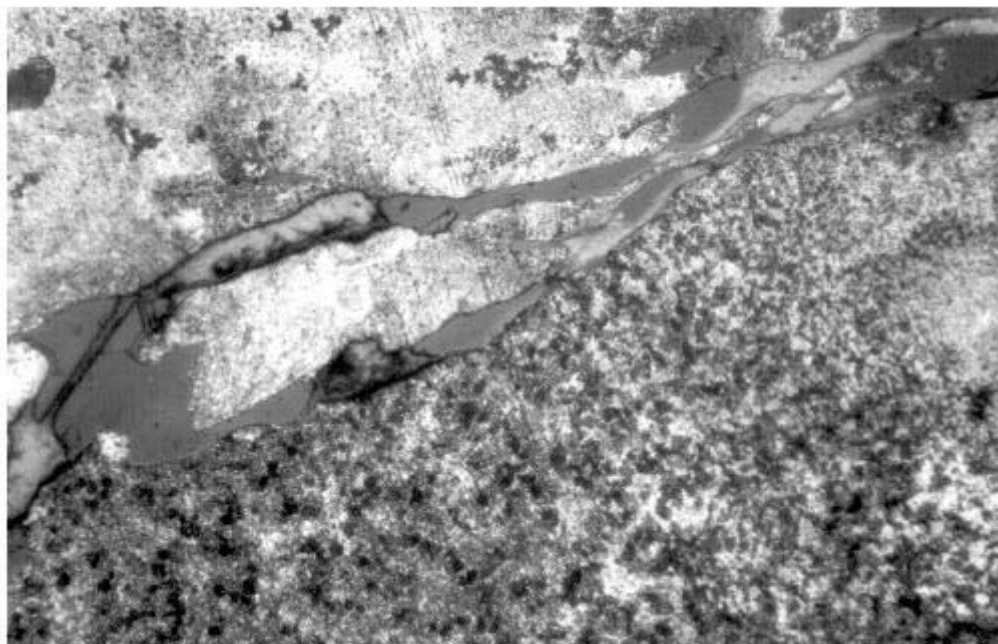
PT/2064/1. Fotografia 1. Imatge de l'heterogeneïtat en contingut de carboni de la microestructura metàl·lica, amb grans inclusions (x 225 augm.).
