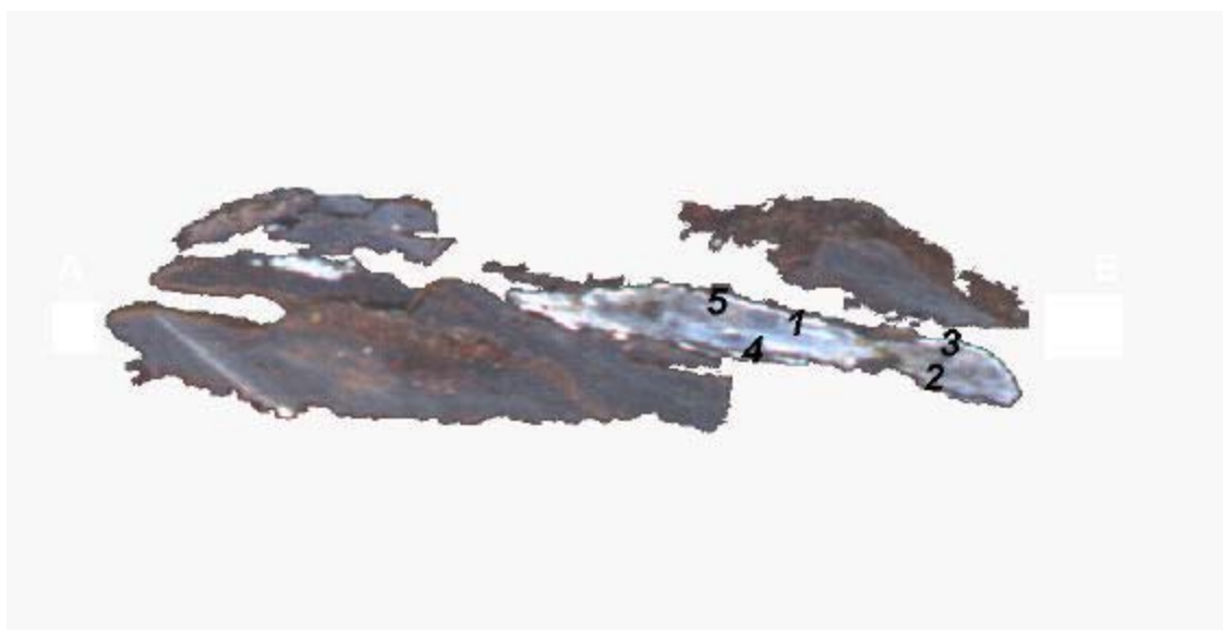
Figura 5. Localització de les microdureses sobre PT/2064/1 (1. 282 HV; 2. 228 HV; 3. 269 HV; 4. 217 HV; 5. 264 HV.)
