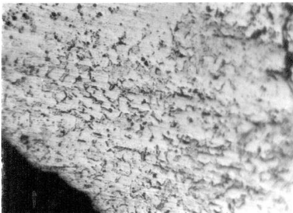
PT/2065/1. Fotografia 1. Empremtes de cadenes de carburs sobre matriu oxidada (x 350 augm.).
